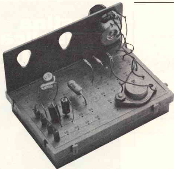
Fig. 6 - Matrice D-DeC con realizzazione di un semplice amplificatore audio.
