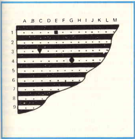
Fig. 11 - Matrice Blob-Board e coordinate per lo studio del piazzamento delle parti; il segno a forma quadra identifica la connessione "1E", quello triangolare la connessione "3C" ed infine il segno ritondo il punto "4G".
